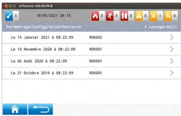
Lorsque l'on sélectionne l'option « Charger », on affiche l'écran suivant qui permet de charger la configuration chantier depuis la clé USB connectée au système :
