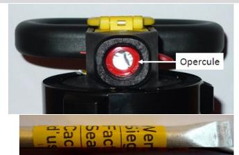
Oter le kit perceur (H) à l'aide d'une pince à bec (2 pièces et 1 joint) et vérifier son état.
