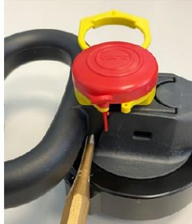
**2** Retirer la poignée ainsi que la bague à remplacer
