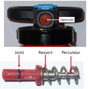
Oter le kit perceur (H) à l'aide d'une pince à bec (2 pièces et 1 joint) et vérifier son état.
