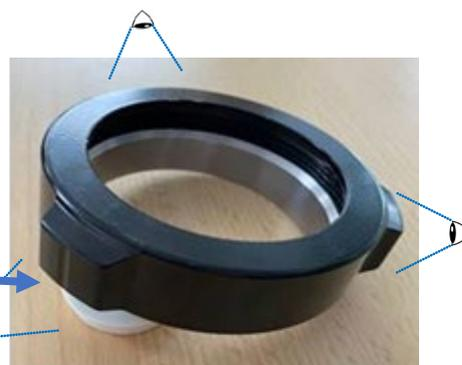
Nettoyer soigneusement la bague et s'assurer qu'elle est en bon état. S'assurer que le filetage de la bague est en bon état. Les filets ne doivent présenter aucune trace de détérioration telles que bavures, arrachement, corrosion. Si la bague (W) présente des signes d'usure, procéder à son remplacement (Se reporter au processus remplacement de la bague ci-dessous).
