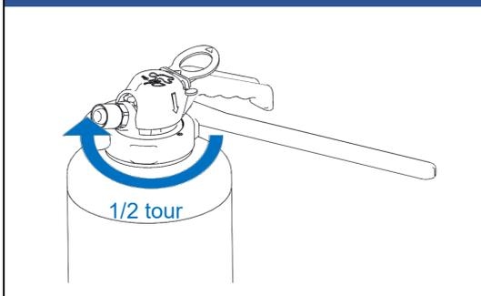
**6** Vérifier le bon serrage de la tête en effectuant avec la poignée des mouvements verticaux et horizontaux. Vérifier visuellement de profil et par le dessus le bon positionnement de la bague sur le filetage du cylindre
