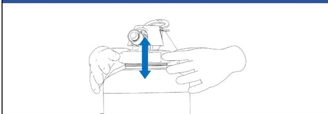
**4** Serrer manuellement d'au minimum 3/4 de tour et jusqu'à résistance
