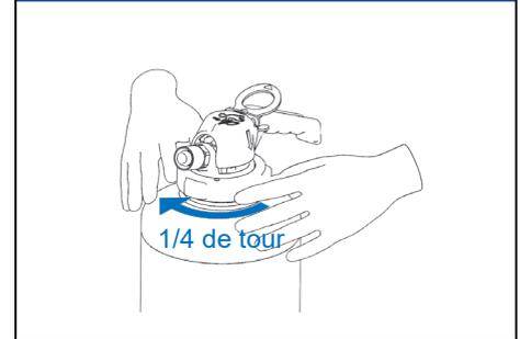
**3** Confirmer le bon engagement de la bague sur le filetage du cylindre en effectuant un mouvement vertical de haut en bas
