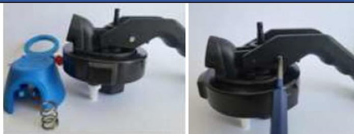
**2** Retirer la poignée ainsi que la bague à remplacer
