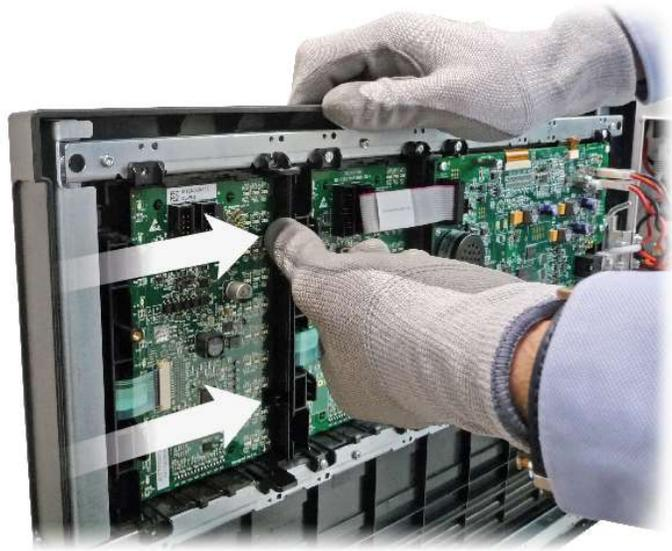
Pousser et appuyer énergiquement sur les deux ergots dans le sens des flèches.
