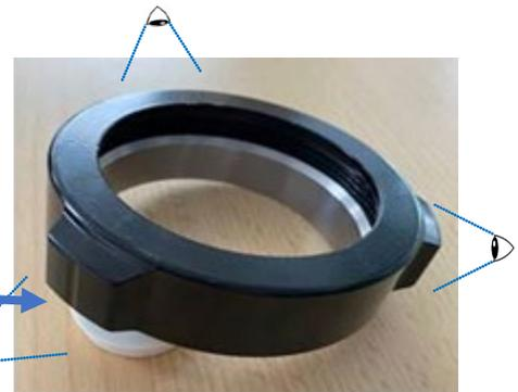
Nettoyer soigneusement la bague et s'assurer qu'elle est en bon état. S'assurer que le filetage de la bague est en bon état. Les filets ne doivent présenter aucune trace de détérioration telles que bavures, arrachement, corrosion. Si la bague (W) présente des signes d'usure, procéder à son remplacement (Se reporter au processus remplacement de la bague ci-dessous).
