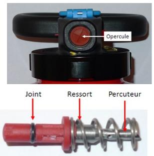
Oter le kit percuteur (H) à l'aide d'une pince à bec (2 pièces et 1 joint) et vérifier son état.
