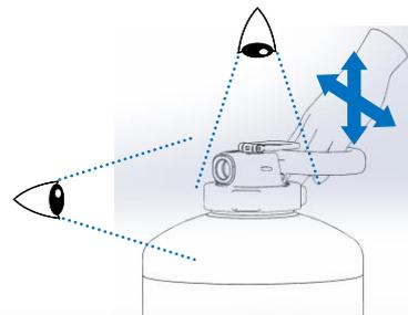
Exemple d'un vissage correct ✓
