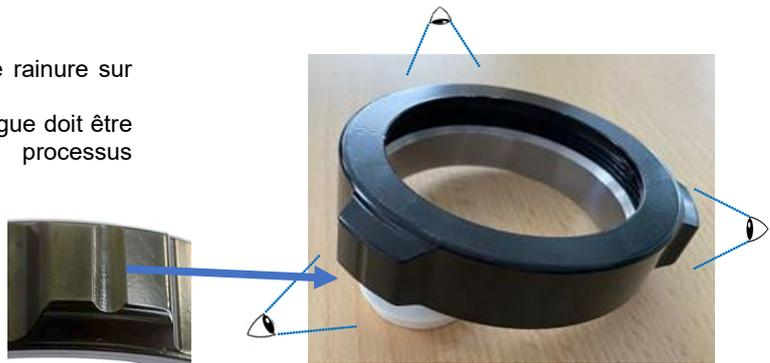
Nettoyer soigneusement la bague et s'assurer qu'elle est en bon état. S'assurer que le filetage de la bague est en bon état. Les filets ne doivent présenter aucune trace de détérioration telles que bavures, arrachement, corrosion. Si la bague (W) présente des signes d'usure, procéder à son remplacement (Se reporter au processus remplacement de la bague ci-dessous).
