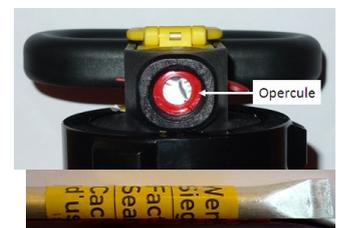
Oter le kit perceur (H) à l'aide d'une pince à bec (2 pièces et 1 joint) et vérifier son état.
