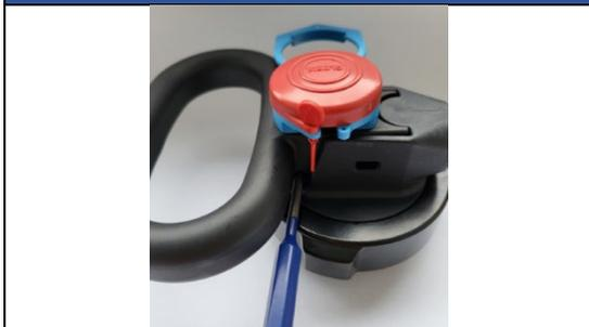
**2** Retirer la poignée ainsi que la bague à remplacer
