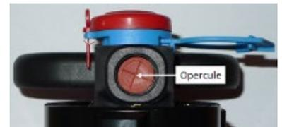
Oter le kit perceur (I) à l'aide d'une pince à bec (2 pièces et 1 joint) et vérifier son état.
