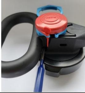
**2** Retirer la poignée ainsi que la bague à remplacer
